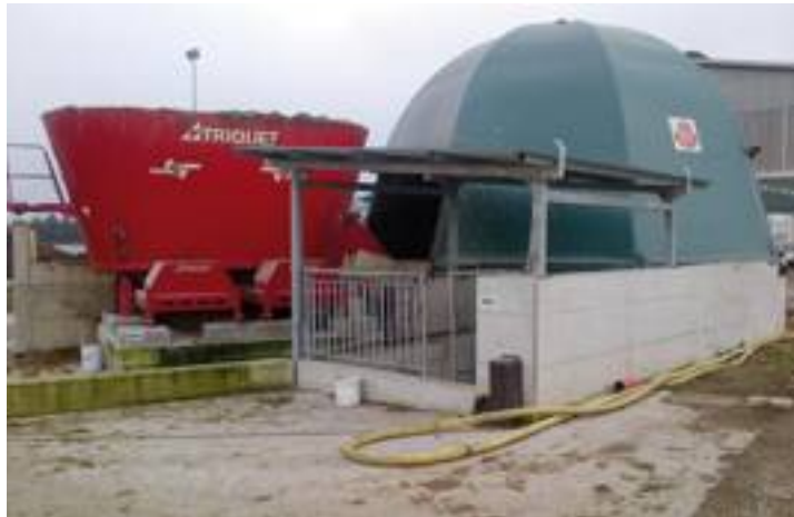
● I liquami prodotti dai 1.800 bovini della stalla Pedrotti sono miscelati con il letame in un carro unifeed statico e avviati poi al digestore.
