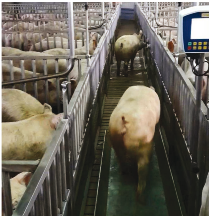
Il sistema Control Weight è in grado di pesare i suini mentre vi camminano sopra.
